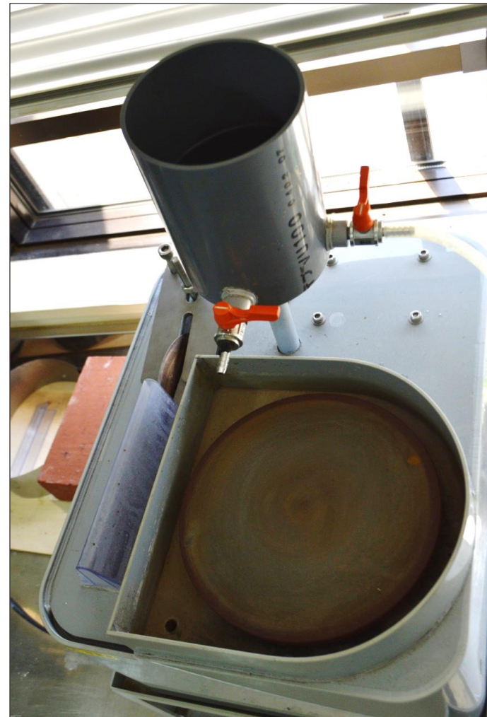
岩石薄片作製 岩石を薄く切ったり砕く機械
